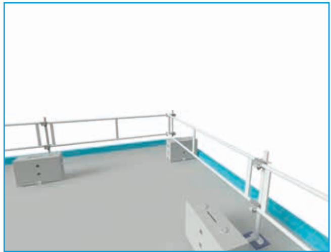
Afbeelding 05: Hoekopstelling met ballastblokken op de hoek.
